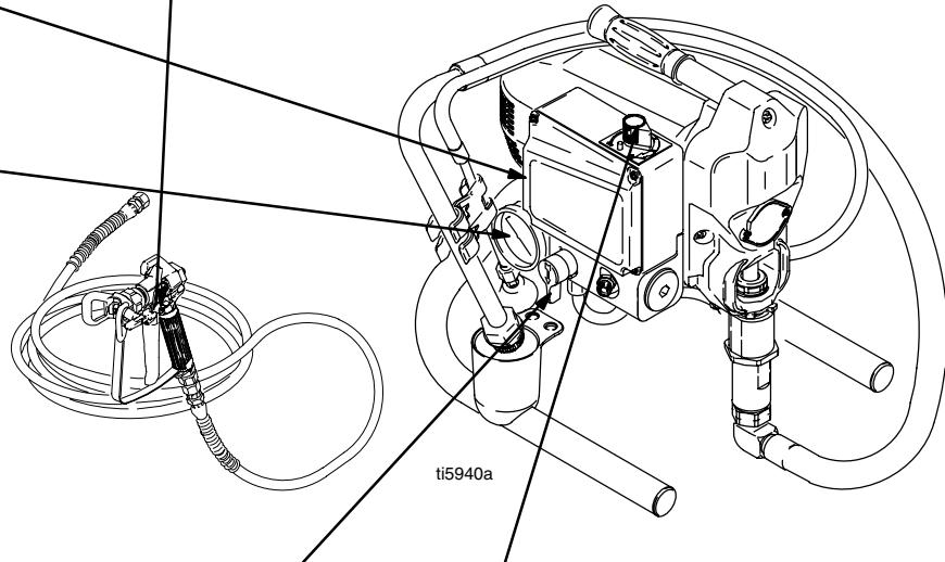
Drain Valve / Vanne de décharge
